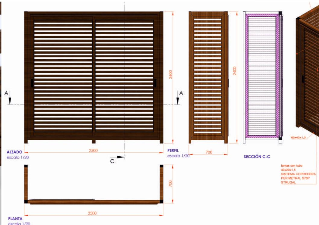
Diseño de solución, con sistema de carpintería en aluminio: serie S70P y estructura tubular de aluminio.
